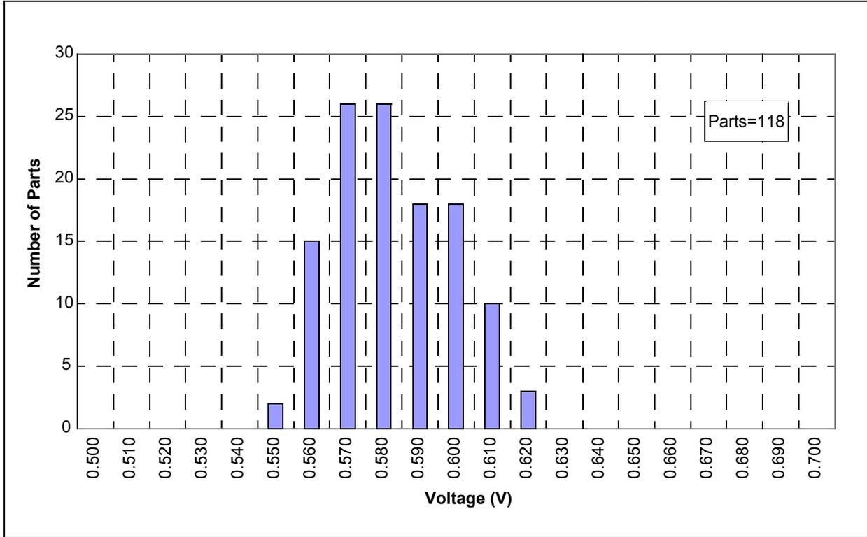
FIGURE 18-51: TYPICAL VP6 REFERENCE VOLTAGE DISTRIBUTION (5V, 85°C)
