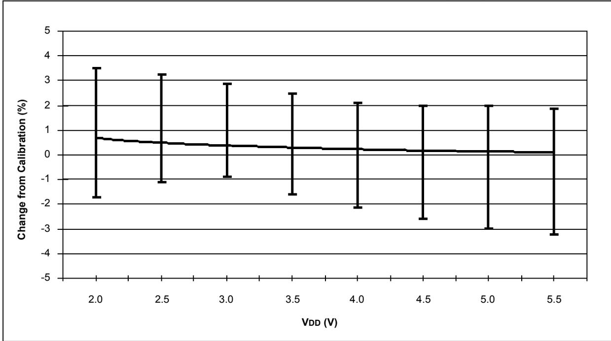
FIGURE 18-43: TYPICAL VP6 REFERENCE VOLTAGE vs. V<sub>DD</sub> (25°C)
