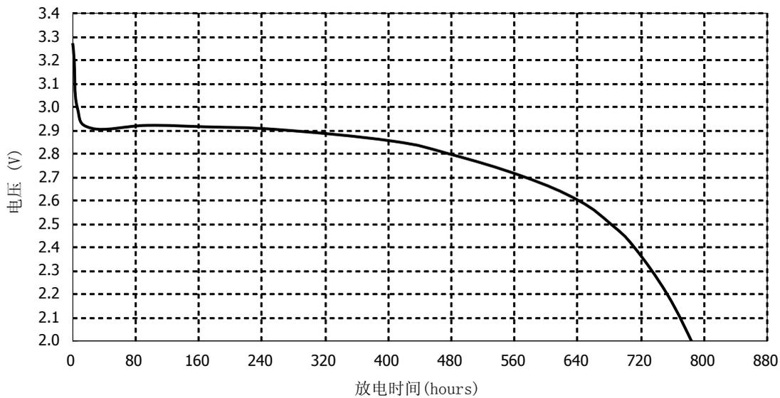
放电方法: 30K $\Omega$  24 小时/天, 终止电压 2.0V温度: 20 $\pm$ 2 $^{\circ}$ C
