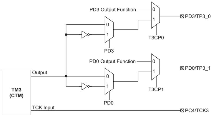
**HT66F50 和 HT66F60 TM0, TM2, TM3 功能引脚控制方框图**
