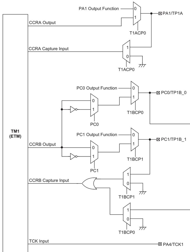
HT66F30 TM 功能引脚控制方框图
