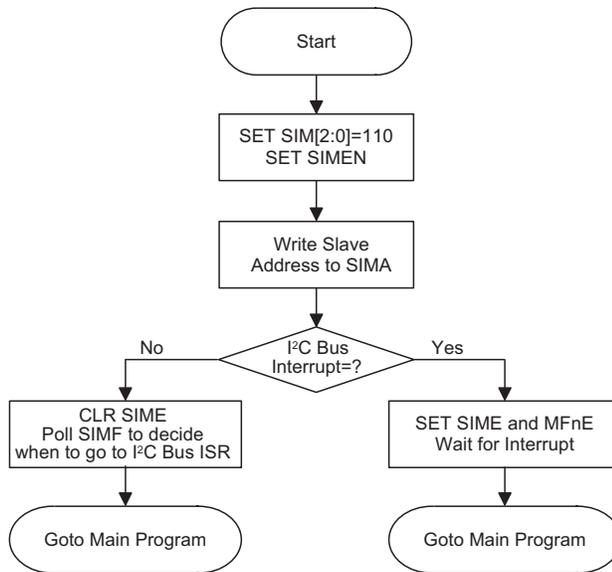
I<sup>2</sup>C 总线初始化流程图
