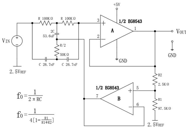
图 7.1a 60Hz 双 T 陷波滤波器, Q=10
