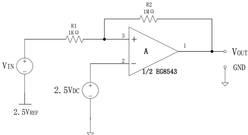
图 7.2 EG8543 的比较器应用——过载检测器
