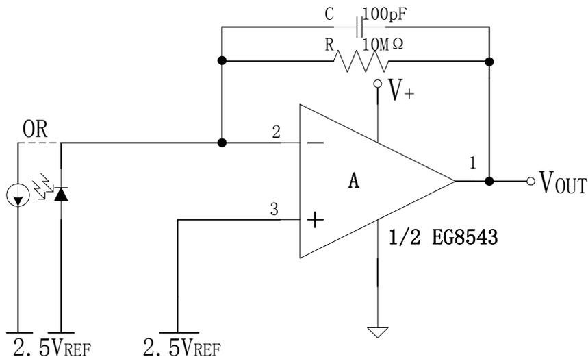
图 7.3 高输入阻抗应用——光电二极管放大器
