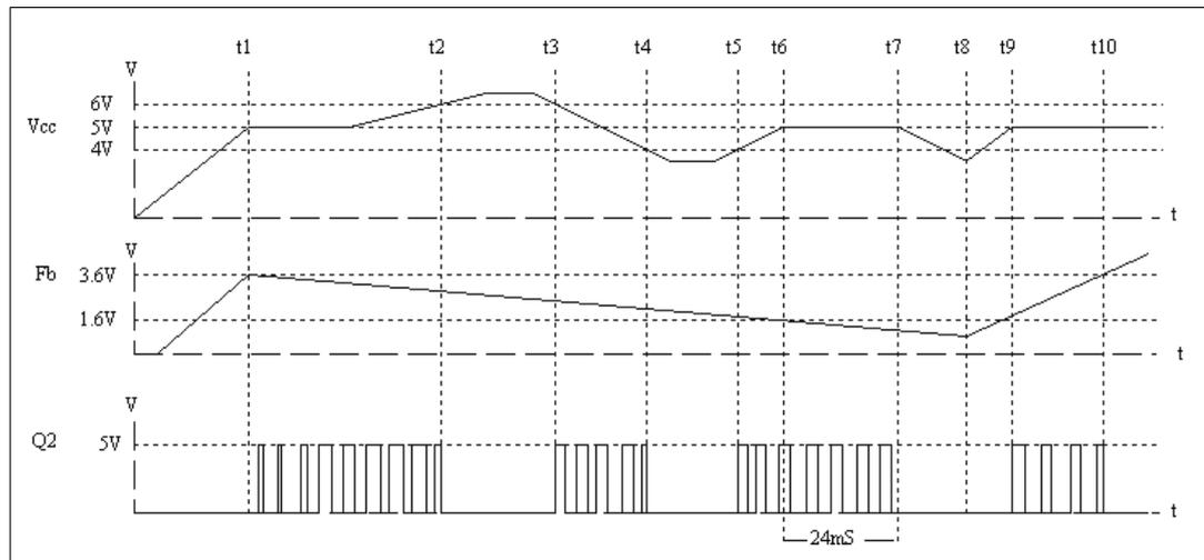
电路在t1 时间Vcc 电压上升到5V，电路开启工作，Q2 输出PWM 信号，t2~t3 时间Vcc 电压高于6V，电路停止输出，Q2 输出低电平，t3~t4 时间Vcc电压回到范围之内，电路正常工作，t4~t5 时间Vcc 电压低于4V，电路停止输出，Q2 输出低电平，t6 时间Fb 电压低于1.6V，开路开启一个24mS 的定时器，PWM 以最大占空输出，直到t7 时间Fb 电压还未能高于1.5V，电路开始重新启动，t9 时间Vcc 电压上升到5V，电路重新开启工作，t10 时间Fb 电压高于3.6V，电路停止输出。
