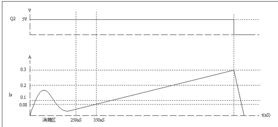
根据电感电流公式  $I = U/L * \Delta t$  可知，在电感不变时，在一个固定的时间上检测电流可计算出电压，芯片利用该原理在350ns 时检测Is 电流，当Is 电流小于0.08V 时，电路正常工作，当Is 电流大于0.08V 时，芯片进入异常保护；同理，当外部的电感器的电感量变小，也会让芯片进入异常保护；这样即可以保护母线电压过高引起的开关管的击穿，也可以保护因外部变压器的饱和或者短路引起的电感量下降导致Is 电流过大，引起芯片的损坏。
