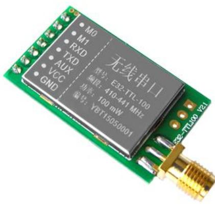
E32-TTL-100 是一款基于 SEMTECH 公司 SX1278 射频芯片的无线串口模块 (UART)，透明传输方式，工作在 410~441MHz 频段(默认 433MHz)，LoRa 扩频技术，TTL 电平输出，兼容 3.3V 与 5V 的 IO 口电压。
