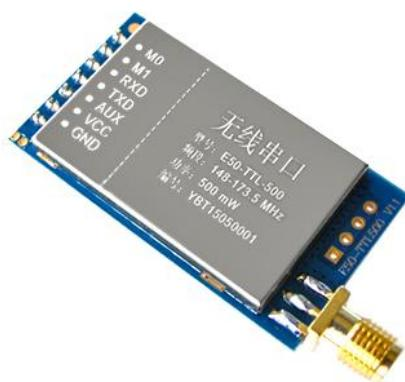
E50-TTL-500 是一款 170M 直插型无线串口模块 (UART)，半双工，收发一体，透明传输方式，发射功率 500mW，工作在 148~173.5MHz 频段 (默认 170MHz)，TTL 电平输出，兼容 3.3V 与 5V 的 IO 口电压，具有空中唤醒功能 (超低功耗)。
