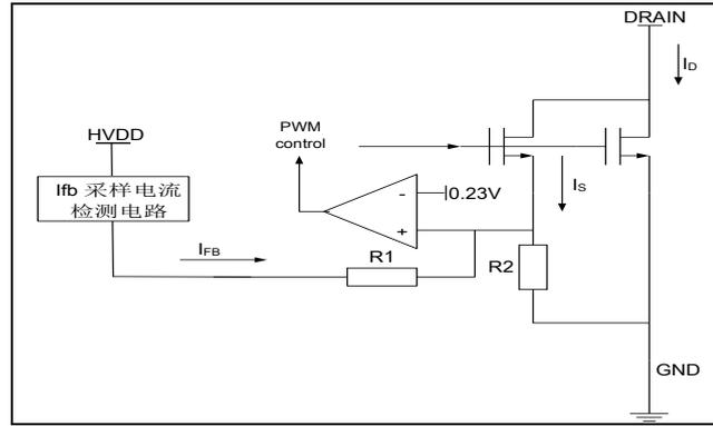
通过高压 MOS 的电流  $I_D$  分成两个部分，其中一部分为  $I_S$ ，这部分电流为芯片采样电流。 $I_S$  与  $I_D$  成比例关系：
