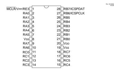
Figure 2. 28-pin QFN VQFN
