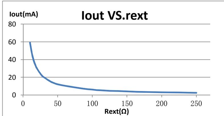
图 1. SM2082G 输出电流与 r<sub>ext</sub> 电阻关系曲线
