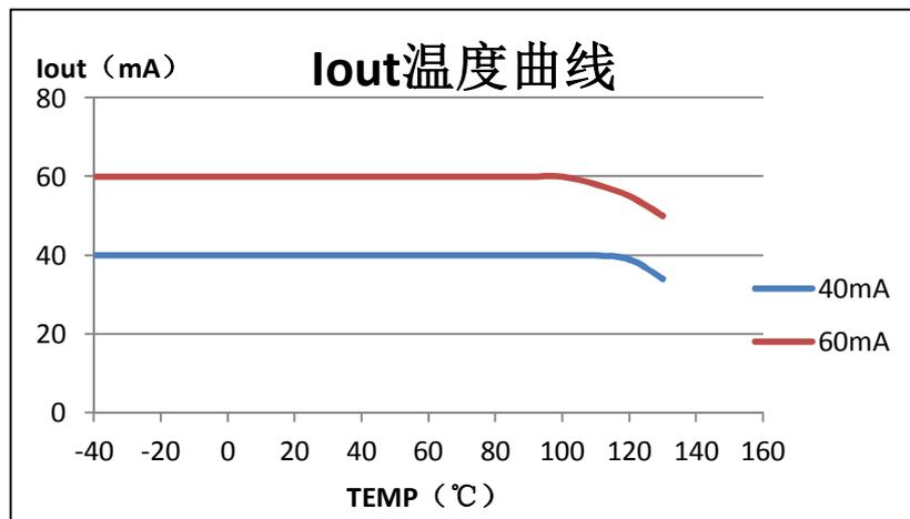
图 3. SM2082G 输出电流温度特性
