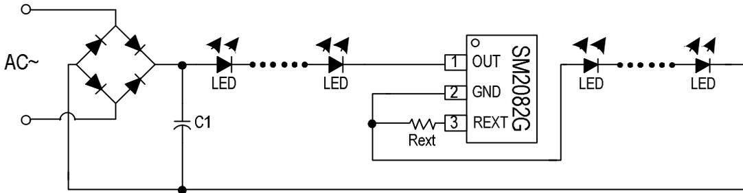
图 7. SM2082G 串接 LED 灯管中
