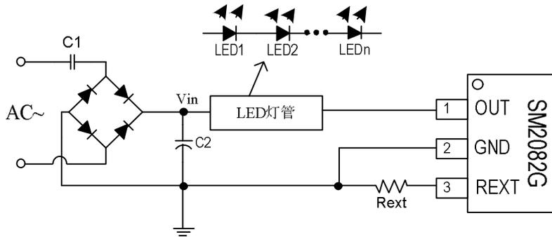
图 5 SM2082G 典型应用电路—交流电源输入
