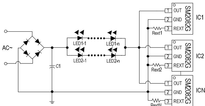
图 6. SM2082G 并联应用电路原理图
