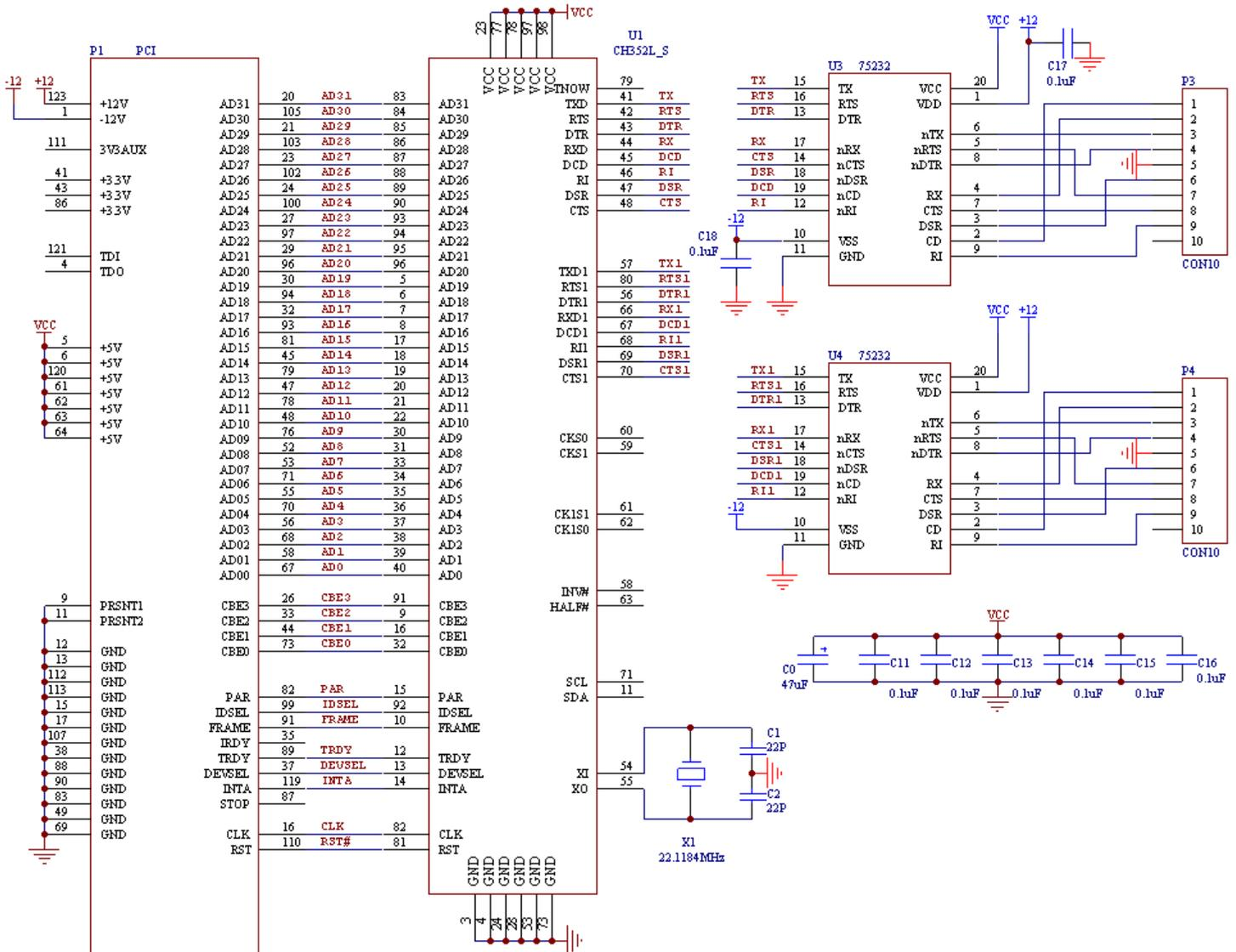
这是基于 CH352 芯片的 PCI 双通道串口的电路。U3 和 U4 是 RS232 电平转换芯片 75232, P3 和 P4 是 10 脚双排针或者 DB9 插针。晶体 X1 和电容 C1 及 C2 用于时钟振荡电路。电容 C0 和 C11~C18 用于电源退耦, C11~C18 是容量为 0.1uF 的独石或者高频瓷片电容, 分别就近并联在 CH352 的三对电源引脚或者 75232 芯片的电源引脚上。
