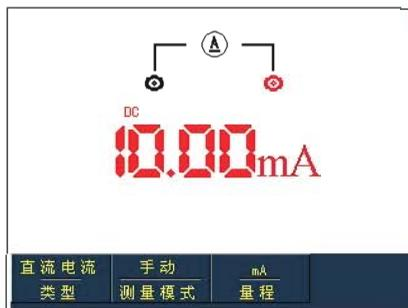
图5-8 小于400mA直流电流测量
