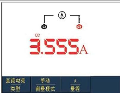
图5-9 大于400mA直流电流测量
