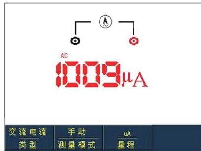
图5-10 小于4mA交流电流测量
