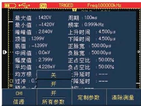
图4-17B UTD1000DL全部参数测量
