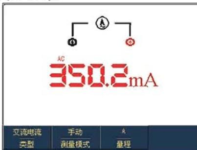
图5-19 测量40mA-400mA的交流流电流
