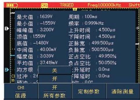
图6-16B UTD1000DL全部参数测量
