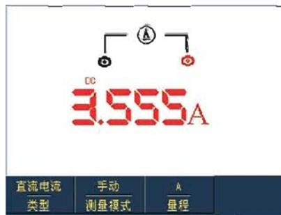
图5-16 大于400mA直流电流测量
