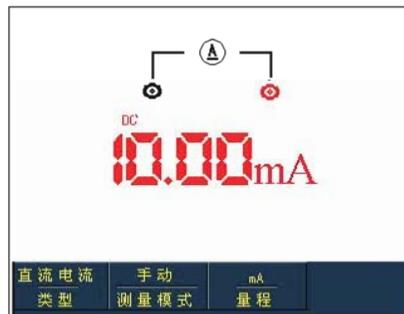
图5-14 小于40mA直流电流测量
