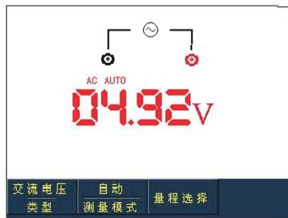
图5-6 交流电压测量
