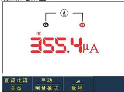
图5-13 小于等于1mA直流电流测量
