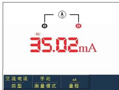
图5-11 小于400mA交流电流测量
