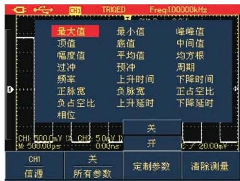
图4-18B UTD1000DL定制参数测量
