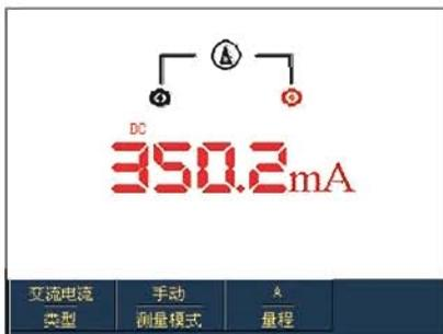
图5-15 测量40mA-400mA的直流电流
