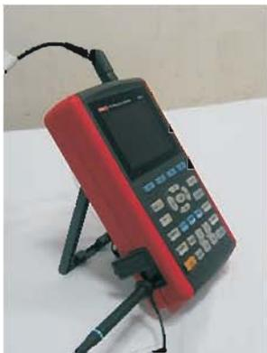
图3-2 本机补偿信号连接
