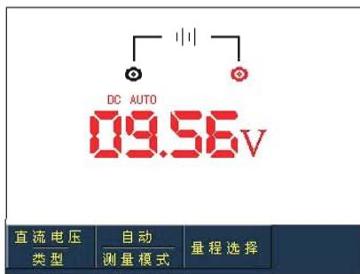
图5-5 直流电压测量
