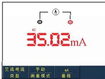
图5-18 小于40mA交流电流测量
