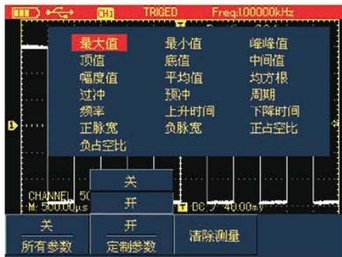
图4-18A UTD1000CL定制参数测量
