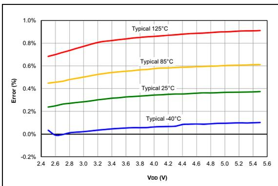
**FIGURE 36-95:** FVR Voltage Error (2x), PIC16F18313/18323 Only
