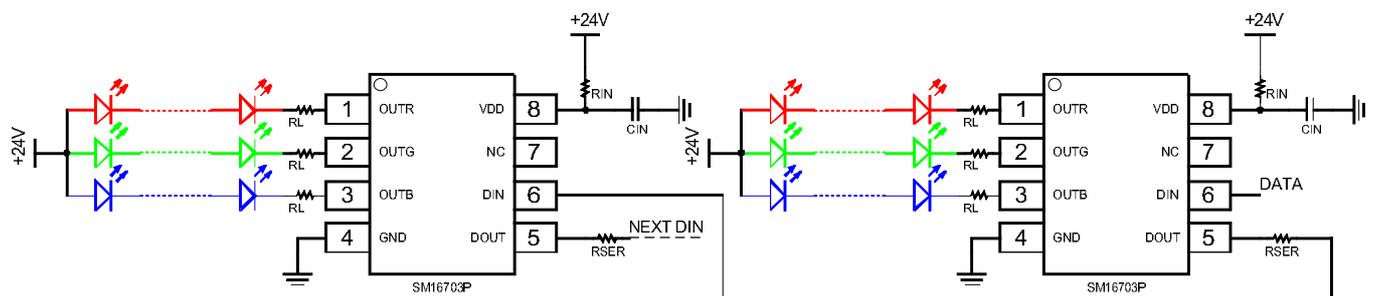
24V 应用方案，建议在信号输出端口串接 470 欧姆电阻  $R_{SER}$  防止带电热拔插或电源和信号线反接情况下损坏 IC 输出端，串接 470 欧姆电阻  $R_{SER}$  两点之间的传输距离可达 5 m。
