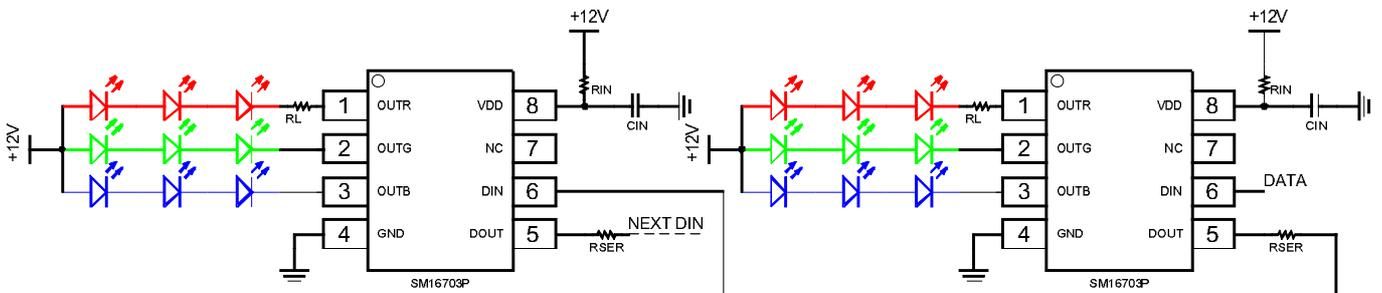
12V 应用方案，建议在信号输出端口串接 180 欧姆电阻  $R_{SER}$  防止带电热拔插或电源和信号线反接情况下损坏 IC 输出端，串接 180 欧姆电阻  $R_{SER}$  两点之间的传输距离可达 10m。
