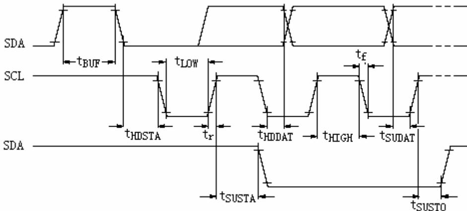
图3. I<sup>2</sup>C总线时序波形
