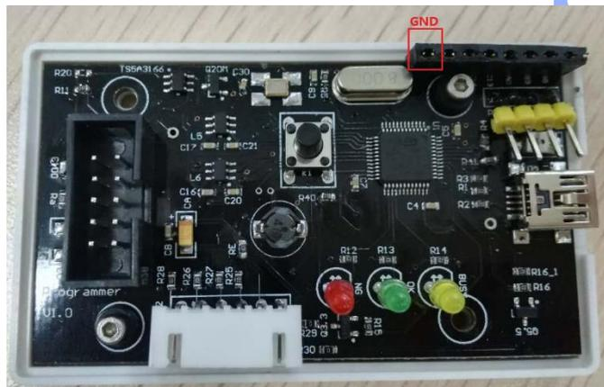
目前设计可接入 TFT 屏，但是需要将上盖打开，插入 TFT 屏,对准 GND。
