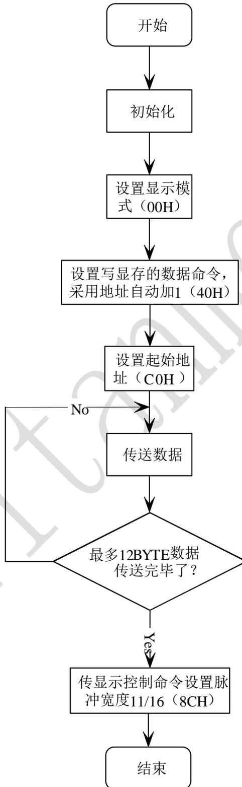
采用固定地址的程序设计流程图:
