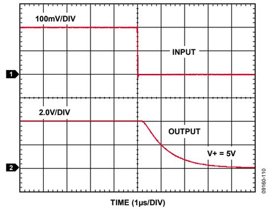
Figure 13. Fall Time ( $V^+ = 5\text{ V}$ )
