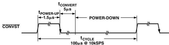
Figure 13. Automatic Power-Down
