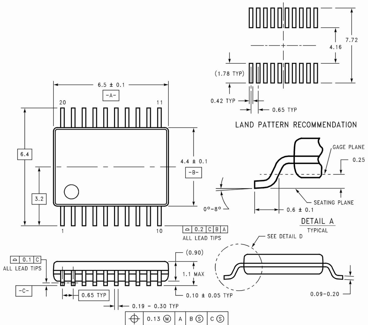
图 4 TSSOP20 封装尺寸图
