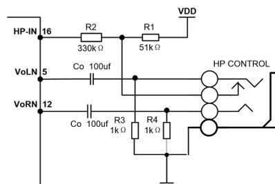
当没有耳机插头接入插孔时，R1-R3 分压电阻使提供到 HP-IN 管脚（16 脚）的电压近似为 50mV(低电平)，使 NS4248 工作于桥式输出模式。当耳机插头插入耳机插孔使得耳机插孔与 R3 分离，HP-IN 管脚上拉到高电平。NS4248 工作于单端输出模式（耳机应用）。
