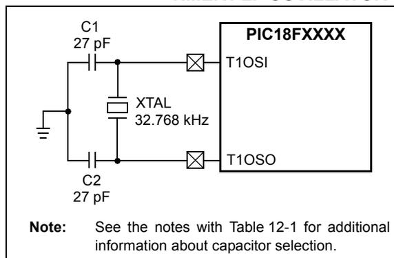
**TABLE 12-1: CAPACITOR SELECTION FOR THE TIMER OSCILLATOR<sup>(2,3,4)</sup>**
