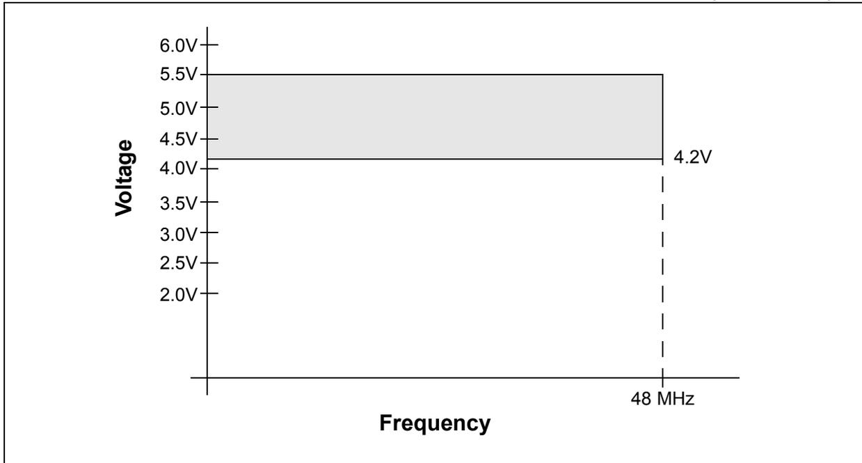
FIGURE 28-2: PIC18LF2455/2550/4455/4550 VOLTAGE-FREQUENCY GRAPH (INDUSTRIAL LOW VOLTAGE)
