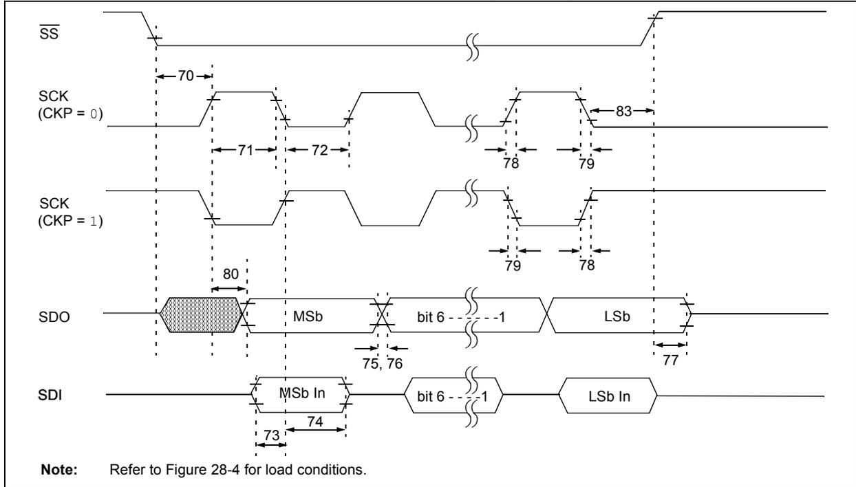
**TABLE 28-17: EXAMPLE SPI MODE REQUIREMENTS (SLAVE MODE TIMING, CKE = 0)**
