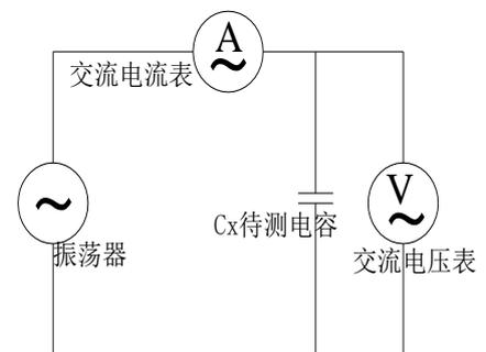
图 3 交流内阻测试电路图
