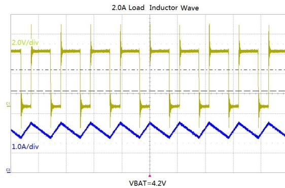
图 10 2A 负载下 SW 端和电感电流波形
