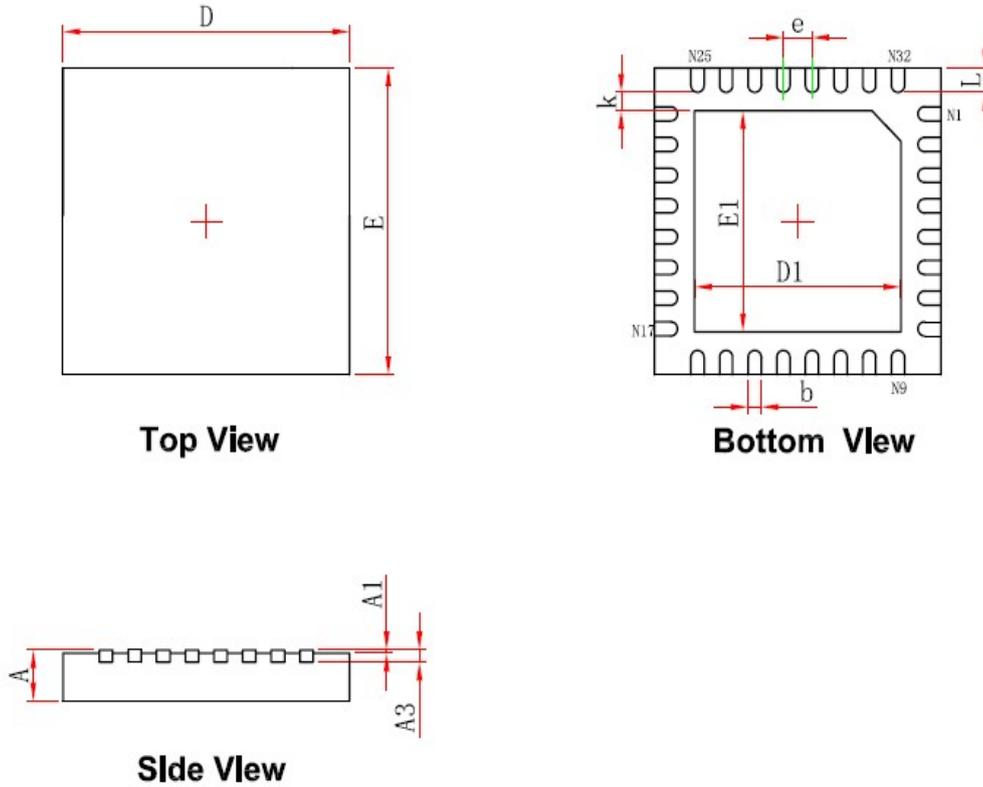
图 13 QFN5x5 -32L
