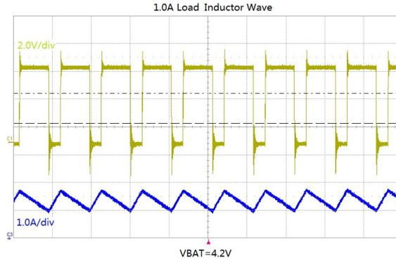
图 8 1A 负载下 SW 端和电感电流波形
