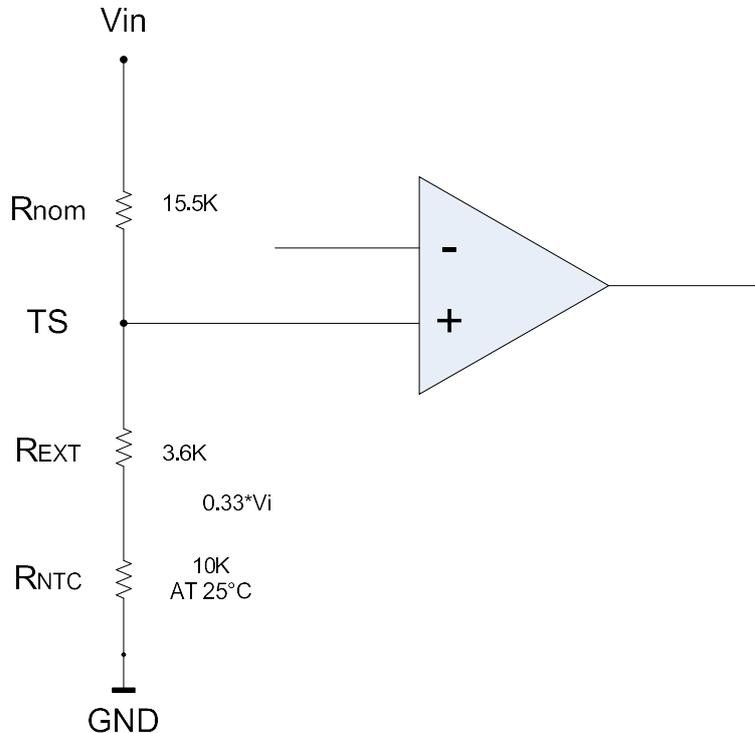
图 12 电池温度检测工作原理
