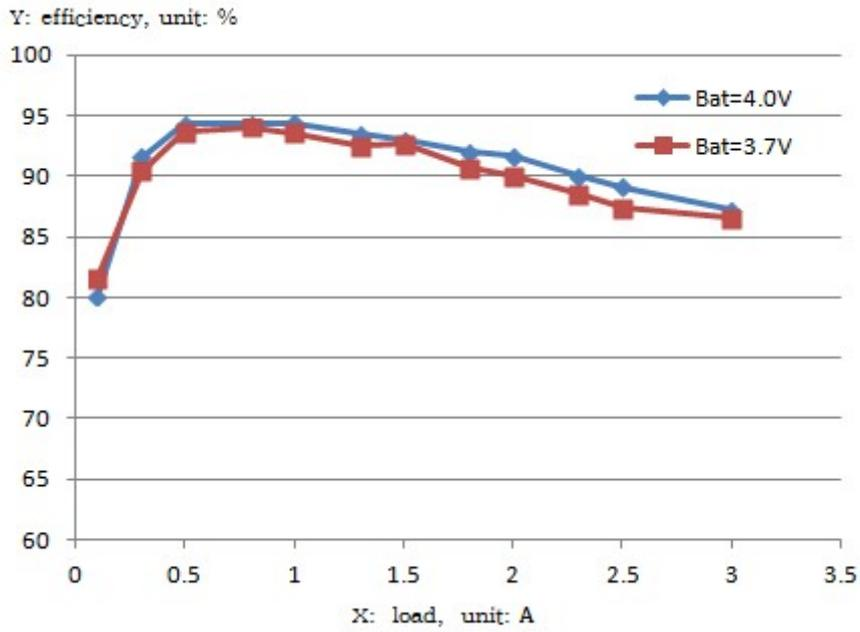
图 5 放电时效率与负载及 BAT 电压曲线
