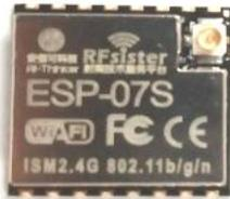
ESP-07S 可广泛应用于各种物联网场合，适用于家庭自动化，工业无线控制，婴儿监控器，可穿戴电子产品，无线位置感知设备，无线定位系统信号以及其它物联网应用，是物联网应用的理想解决方案。
