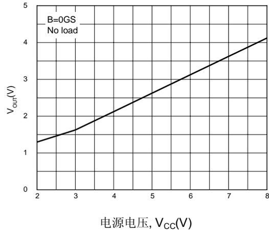
静态输出电压随电源电压的变化
