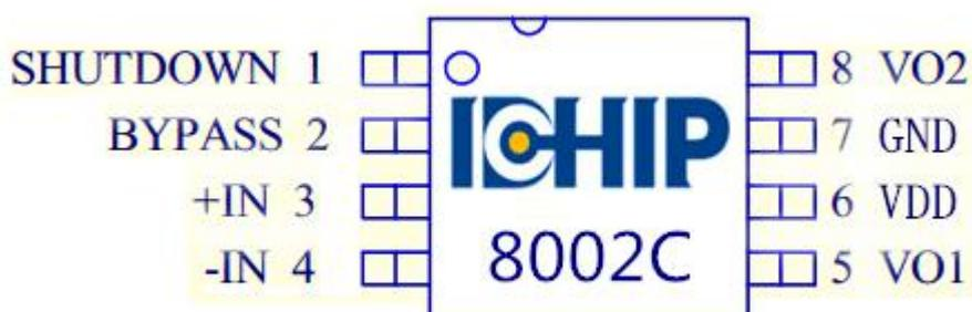
图 2. 8002C SOP-8 封装管脚分布图
