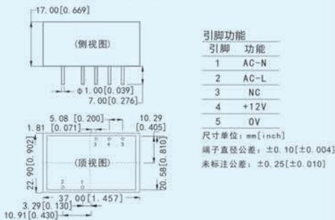
AC220S\_DC-10/12WH2(过EMC,隔离耐压4000VAC,输入90-305VAC)系列 40.00×25.00×20.80 (mm)
