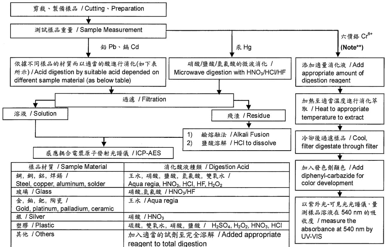
Note\*\*: (1) 針對非金屬材料加入鹼性消化液，加熱至 90~95°C 萃取。 / For non-metallic material, add alkaline digestion reagent and heat to 90~95°C.
