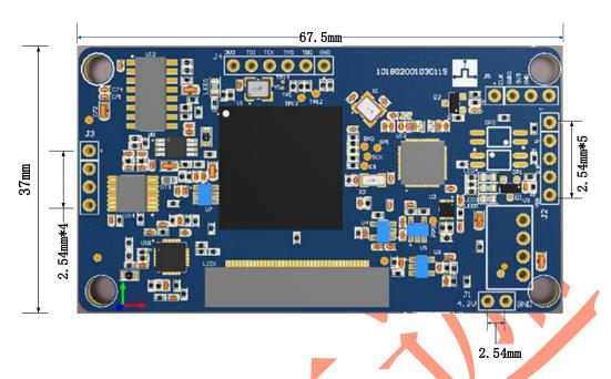
具体尺寸如上图所示,单位均为毫米,模组左边有 4 个 2.54mm 间距的插座连接孔,右侧有 5 个 2.54mm 间距的插座连接孔。
