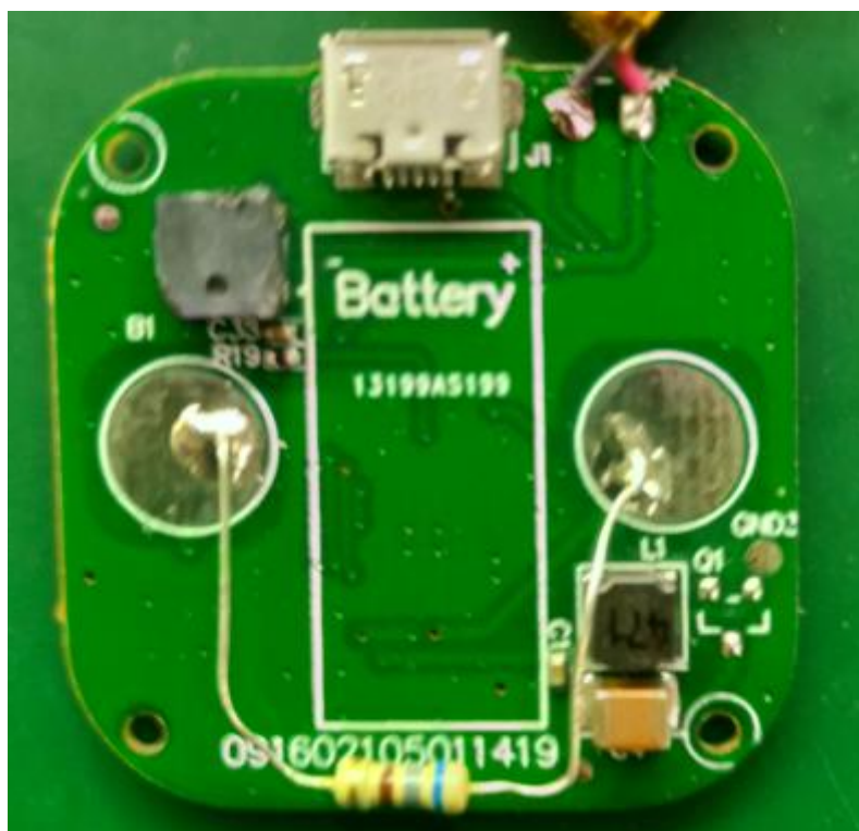
图 6 两个刺激接口间串联 500 欧姆左右的电阻
