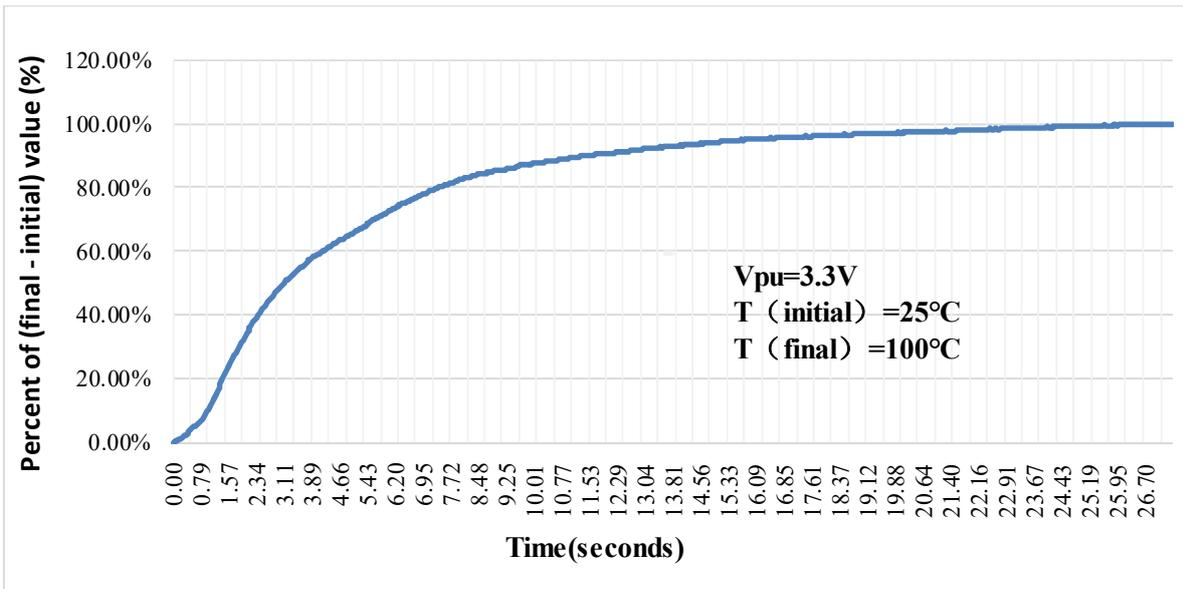
图3.3 在空气中热响应测试 (To-92s)
