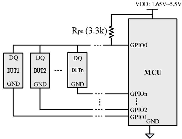
图 5.4 使用 NST1001 进行多点温度采集
