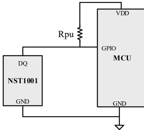
图 5.1 一个单片机 GPIO 端口的应用图
