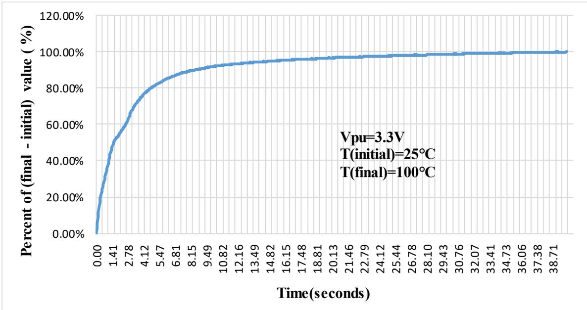
图 3.4 在空气中热响应测试 (DFN2L)
