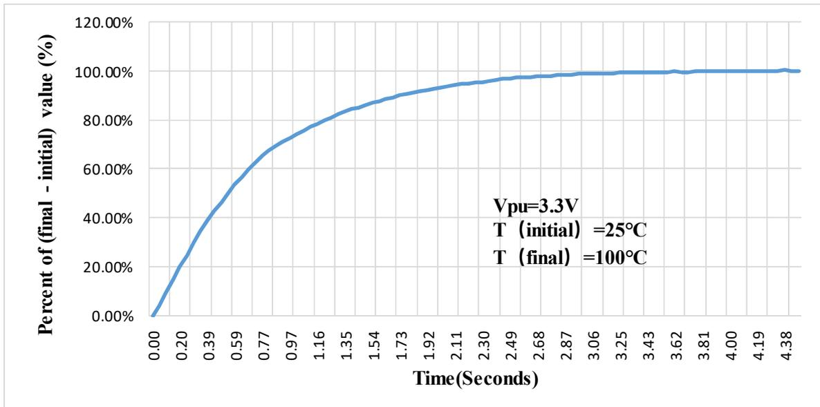
图 3.5 在硅油中热响应测试 (To-92s)
