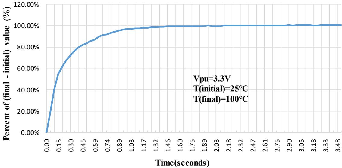
图 3.6 在硅油中热响应测试 (DFN2L)
