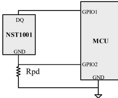
图 5.3 下拉电阻连接应用图
