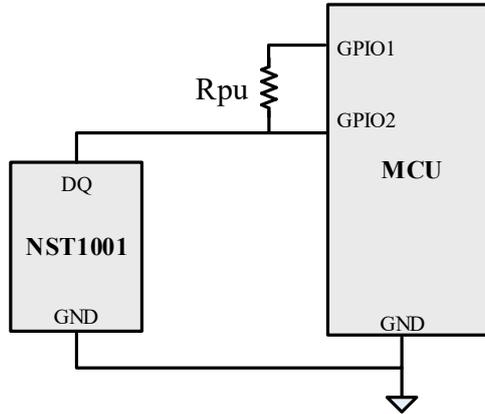
图 5.2 待机零功耗应用图
