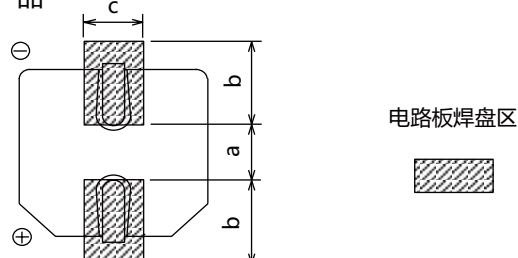
(推荐电路板焊盘尺寸)
