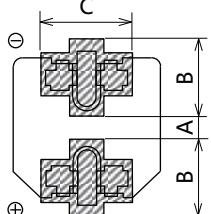
(推荐电路板焊盘尺寸)
