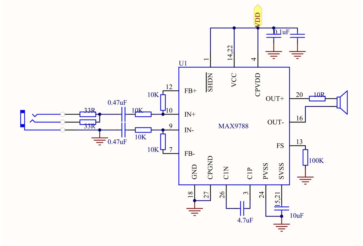
8.5 以上几种方案电源为2.7~5.5V的低电压信号，若使用更高的电源电压信号，可采用其它方案。
