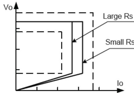
图 2 调整  $R_S$  调整 CC 点和  $V_O$  示意图
