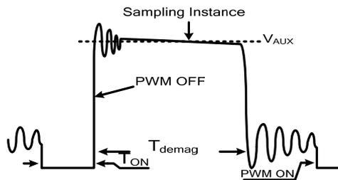
图 1 辅助绕组上电压波形曲线
