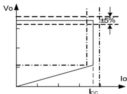
在恒流控制时，最大输出电流和输出功率可以通过 CS 引脚的限流电阻  $R_s$  设定。在恒压控制时，内置恒压采样电路以及高精度的误差比较器基准电压保证了芯片的高性能和高精度。此外，内置线损补偿电路保证了从空载到满载条件下输出电压精度。芯片还具有极低的
