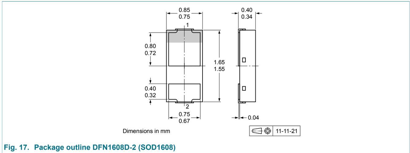
Fig. 17. Package outline DFN1608D-2 (SOD1608)
