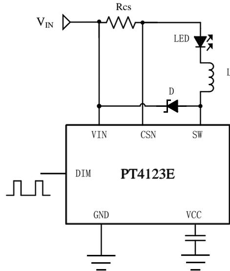
通过PWM调光，LED的输出电流可以从0%到100%变化。LED的亮度是由PWM信号的占空比决定的。例如PWM信号25%占空比，LED的平均电流为(0.2/Rcs)的25%。建议设置PWM调光频率在100Hz以上，以避免人的眼睛可以看到LED的闪烁。PWM调光比模拟调光的优势在于不改变LED的色度。PT4123E调光频率最高可超过20kHz。
