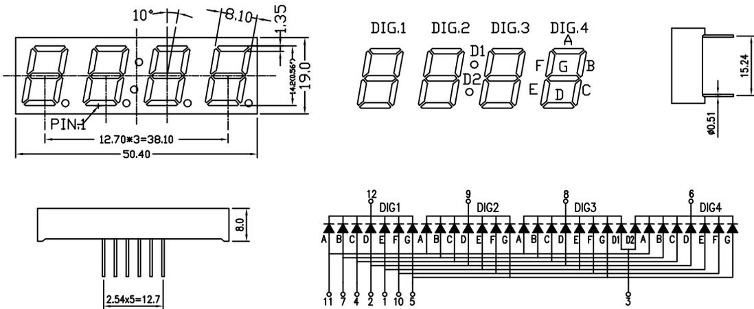
管脚顺序：从数码管的正面观看，以最左下边第一脚为起点，管脚的顺序是逆时针方向排列
