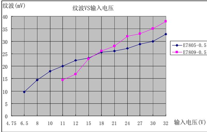
图 3: 纹波 VS 输入电压
