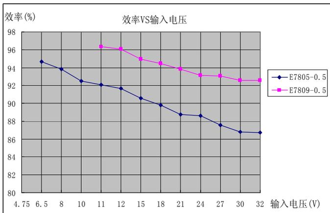
图 1: 效率 VS 输入电压
