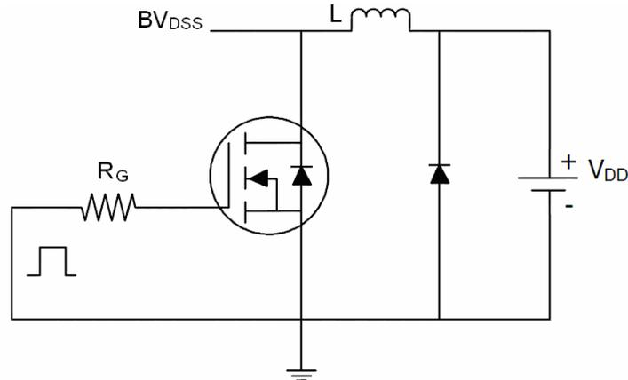
**2) Gate charge test Circuit**
