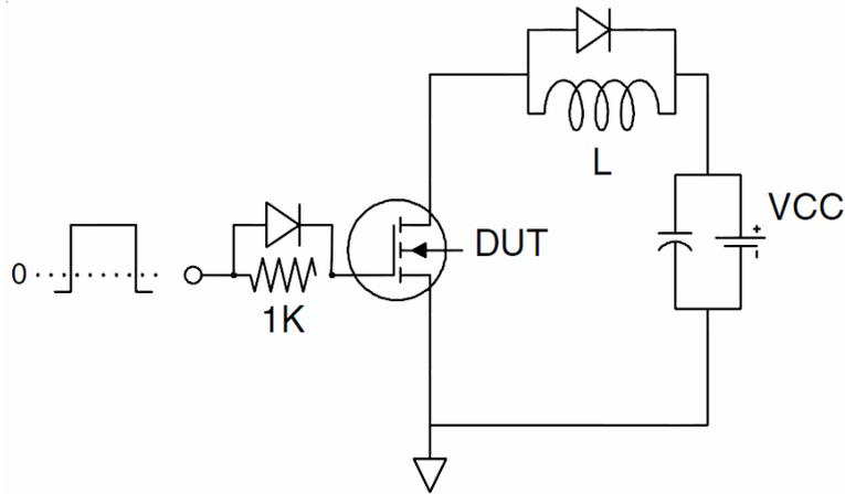
**3) Switch Time Test Circuit**
