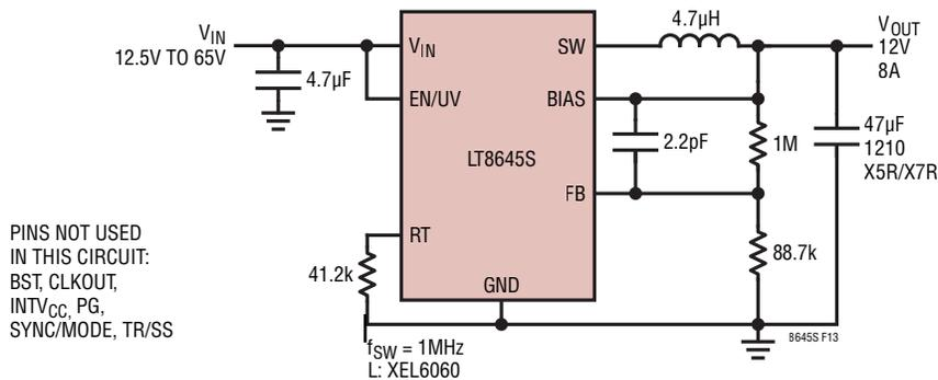
Figure 13. 12V, 8A Step-Down Converter
