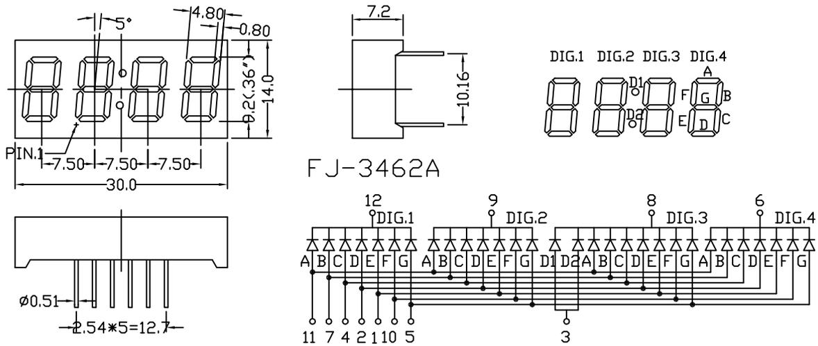
管脚顺序: 从数码管的正面观看, 以最左边第一脚为起点, 管脚的顺序是逆时针方向排列
