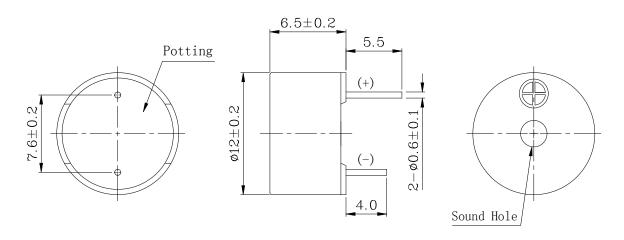
Unit:mm Tolerance:  $\pm 0.5$ mm
