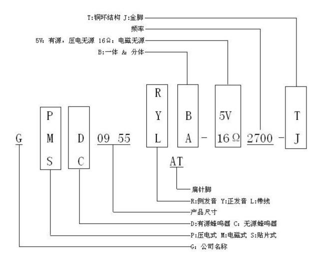
注:有源蜂鸣器用"yoc"驱动; 无源压电蜂鸣器用"yp-p"驱动; 无源电磁蜂鸣器用"yo-p"驱动;
