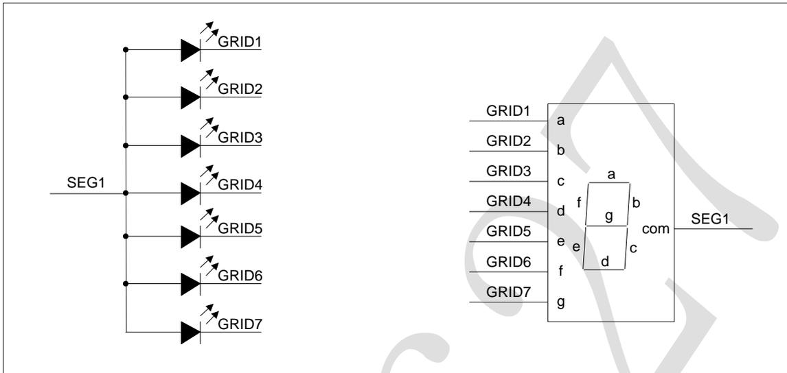
图 4-2: 驱动共阳极数码管连接示意图
