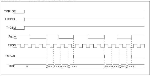
FIGURE 27-5: TIMER1 GATE SINGLE-PULSE MODE
