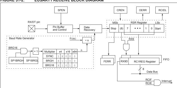
FIGURE 31-2: EUSART1 RECEIVE BLOCK DIAGRAM
