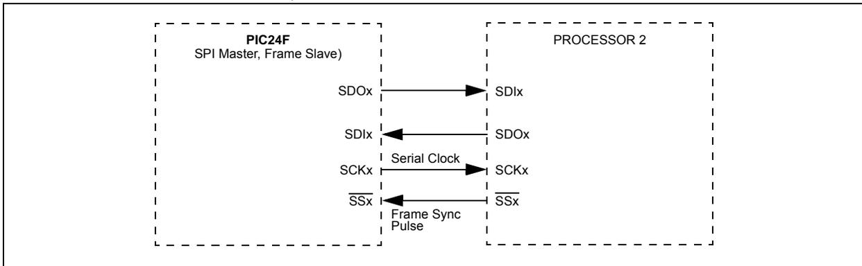
**FIGURE 15-7: SPIx SLAVE, FRAME MASTER CONNECTION DIAGRAM**
