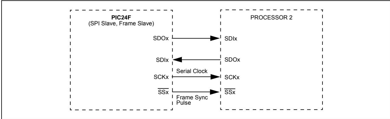
**FIGURE 15-6: SPIx MASTER, FRAME SLAVE CONNECTION DIAGRAM**
