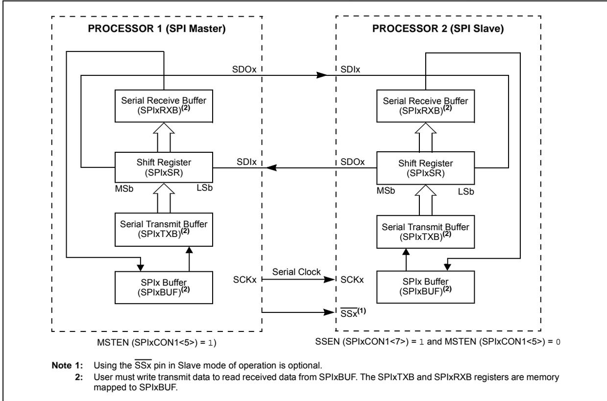
**FIGURE 15-4: SPIx MASTER/SLAVE CONNECTION (ENHANCED BUFFER MODES)**
