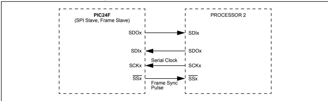
**FIGURE 15-8: SPIx SLAVE, FRAME SLAVE CONNECTION DIAGRAM**
