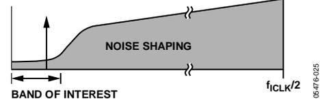
Figure 24.  $\Sigma$ - $\Delta$  ADC, Noise Shaping
