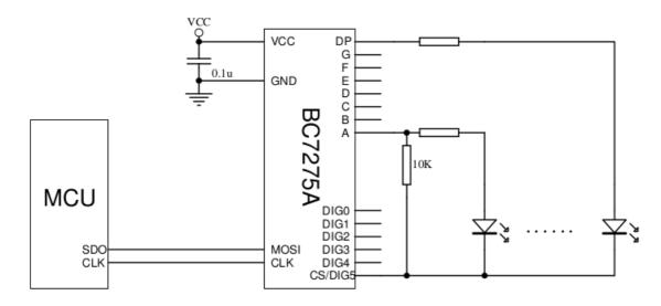
一般 MCU 上 SPI 接口均可设置不同的工作模式,与 BC7275(A)相连时,应该设置成主机(Master)模式,CLK 空闲时高电平,数据在第一个时钟沿传递,在第二个时钟沿采样。接口的时钟频率,必须在 64KHz 以下。
