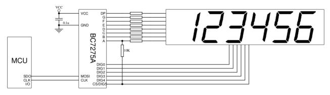
BC7275A用作6位数码管驱动时,电路中增加了一只连接 CS/DIG5 和 A 驱动的 10K 电阻,该电阻可连接于 A-DP 段的任意一根段驱动,该电阻并不是必须的,但接入该电阻有助于 BC7275A 可靠地工作于6位模式。
