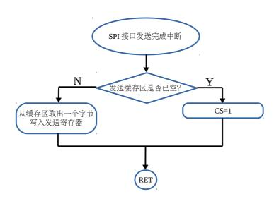
注:在中断方式下,因为缓冲区的存在,"发送一个指令"子程序的调用和数据实际在 SPI 口上发出的时间会有不同步的问题,因此,不能如其它两种方式一样在"发送一个指令"子程序中控制 CS 片选信号的电平变化。比较好的方式是,在"发送一个字节"子程序中,检查如果当前 SPI 口处于空闲状态,则先将 CS 信号置低,然后将数据写入 SPI 口发送寄存器开始发送。在 SPI 口中断处理程序中,如果发现当前缓冲区已经为空,表示所有数据均发送完成,此时将 CS 恢复为高电平。这个方式和在"发送指令"子程序中控制 CS 效果有所区别,在"发送指令"子程序中控制 CS 时,CS 信号随每个指令都会跳变一次;中断方式下,CS 则按指令组为跳变,每组连续发出的指令中间,CS 都将维持在低电平,直至所有数据发送完成,才会恢复为高电平。
