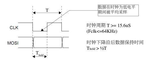
对于使用硬件 SPI 接口的情况,请设置 SPI 接口为如下参数: CLK 空闲状态为高电平,数据在第一个时钟沿(下降沿)改变,在第二个时钟沿(上升沿)被采样,串口速率≤64Kbps.
