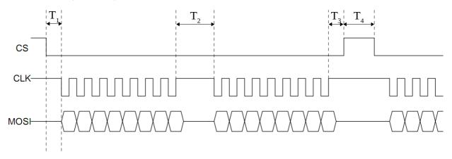
图中, $T_1$ 为指令中 $\overline{CS}$ 下降沿到第一个CLK时钟脉冲下降沿的时间,此时间要求大于½个时钟周期  $T_1$  当使用硬件 SPI 接口时,从数据写入 SPI 接口发送寄存器到第一个时钟脉冲输出,一般会自动加入约 1 个时钟周期的延时,用户使用时程序中先将 $\overline{CS}$  置低电平,然后写入 SPI 接口寄存器即可,对此延时可不予考虑,但如果所用 MCU 的 SPI 接口没有此特性,或者使用软件模拟 SPI 接口,则需人工加入此延时。
