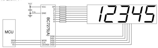
BC7275A 也可以利用 CS/DIG5 引脚驱动数码管,构成 6 位显示:
