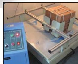
模拟运输振动试验机
