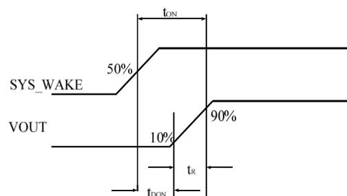
Figure 18. SYS\_WAKE vs. V<sub>OUT</sub>
